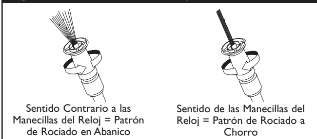
Figura 28 — Ajustar el Patrón de Aspersión
